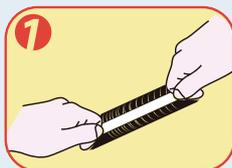
1 Aplicamos la cinta doblecara a lo largo de la tubería a aislar
