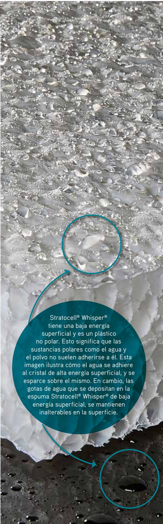
Stratocell® Whisper® tiene una baja energía superficial y es un plástico no polar. Esto significa que las sustancias polares como el agua y el polvo no suelen adherirse a él. Esta imagen ilustra cómo el agua se adhiere al cristal de alta energía superficial, y se esparce sobre el mismo. En cambio, las gotas de agua que se depositan en la espuma Stratocell® Whisper® de baja energía superficial, se mantienen inalterables en la superficie.
