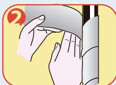
2 Cubrimos la tubería con el Aislamiento PolyREFLEX®
