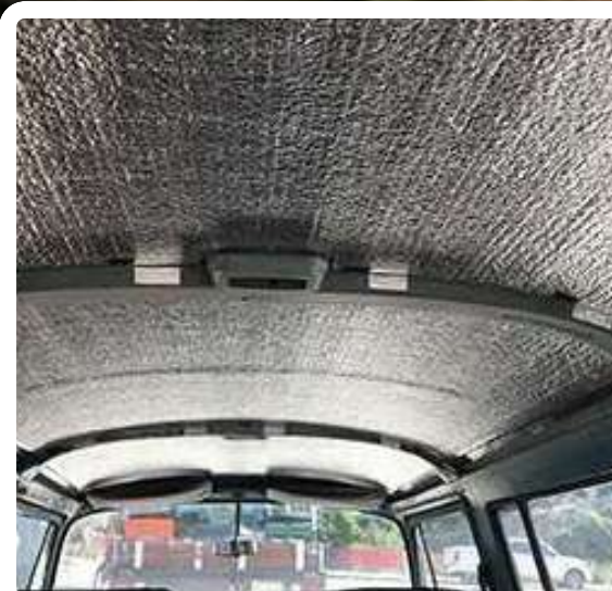
Aislamiento en techo
